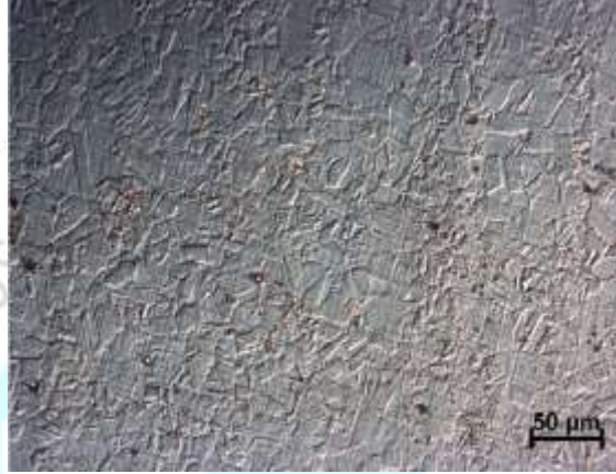
Görsel 1. Inconel 625 alaşımının dağlanmış konumunda mikroyapısını gösteren IM görüntüsü.
