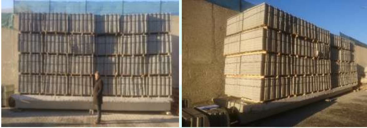
Görsel 17. TT-Kiriş'in 1x(1,4G+1,6Q) Yükü ile Yüklü Hali
