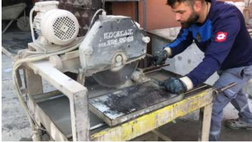
Görsel 5. Karot örneğinin cidar kesilerek hazırlanması
