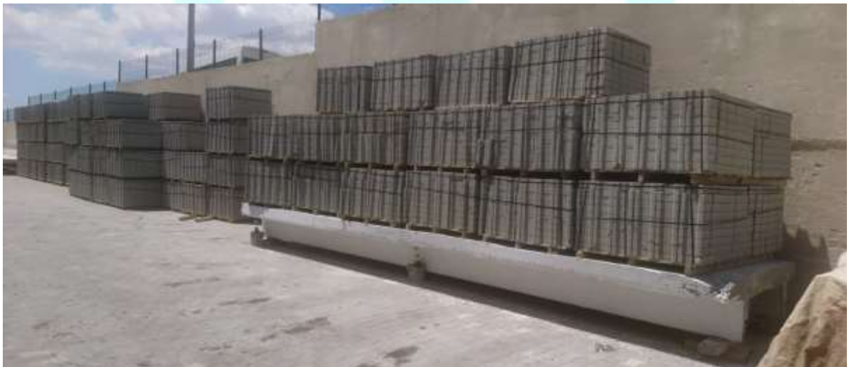
Görsel 11. TT-Kiriş'in 0,85x(1,4G+1,6Q) Yüğü ile Yüklü Hali
