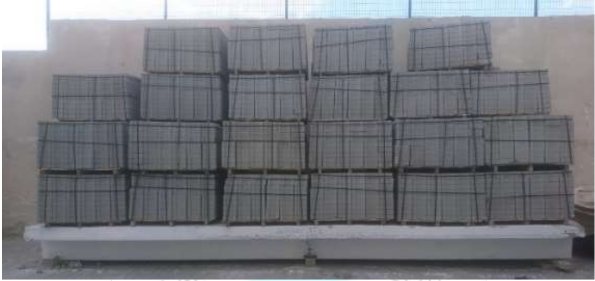
Görsel 14. TT-Kiriş'in 1x(1,4G+1,6Q) Yüğü ile Yüklü Hali
