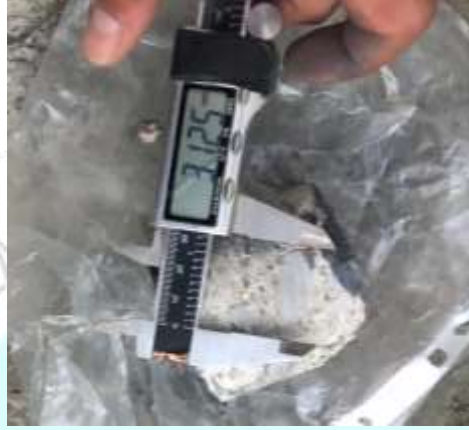
Görsel 1. Karot içerisindeki maksimum agrega boyutu
