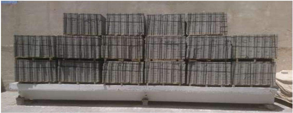
Görsel 10. TT-Kiriş'in 0,85x(1,4G+1,6Q) Yükünün Yükleme Sırası
