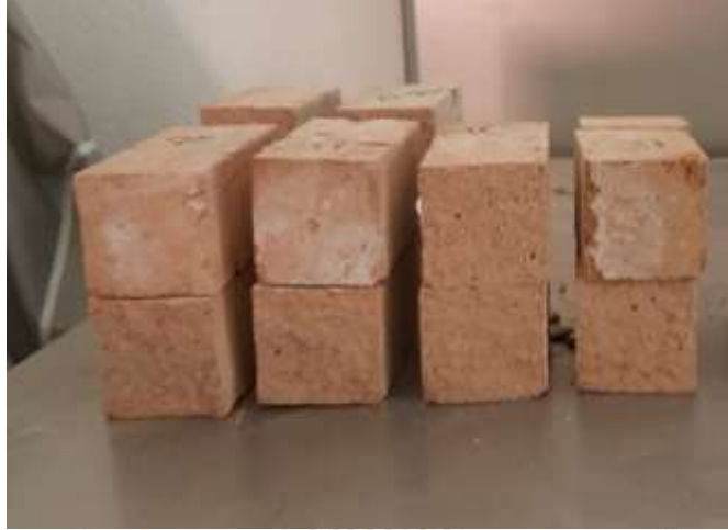
Görsel 2. Silis dumanı ve bor atığı katkılu tuğla numuneleri
