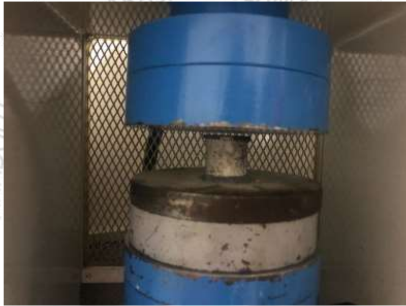
Görsel 6. Karotun numuneleri başlandıktan sonra basınç testi
