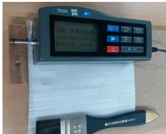
Görsel 2. YüzeY pürüzlülük ölçümü
