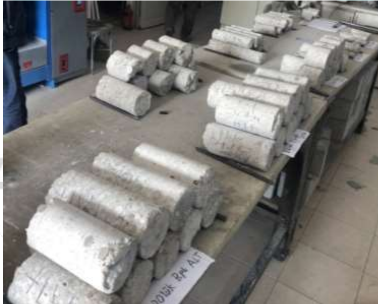
Görsel 4 Alınan Karot Numuneleri
