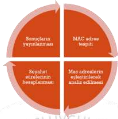
Görsel 5 Bluetooth Okuyucu ile Seyahat Süre Hesabı
