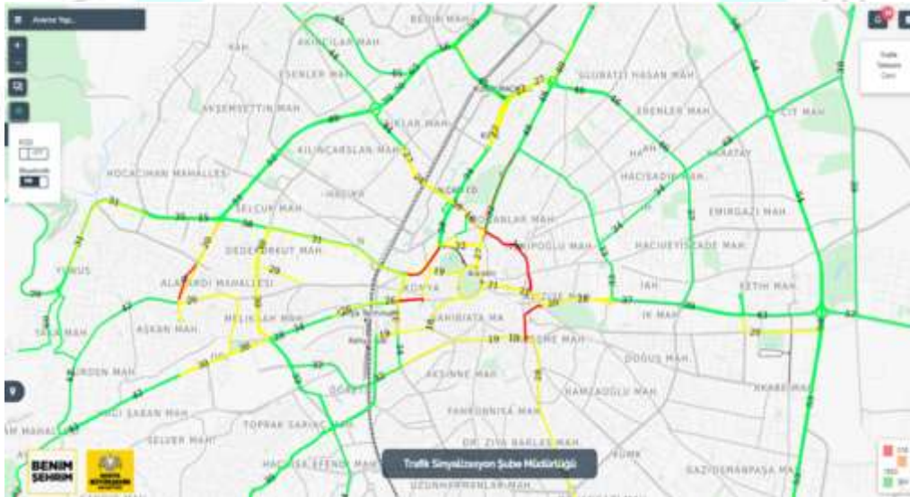
Görsel 4 Konya'da ISSD firması tarafından geliştirilen Bluetooth okuyucular ile tespit edilen Trafik Yoğunluğunun gösterimi [5]
